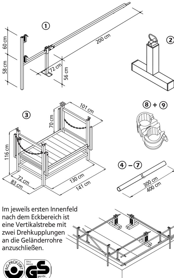
Im jeweils ersten Innenfeld nach dem Eckbereich ist eine Vertikalstrebe mit zwei Drehkupplungen an die Geländerrohre anzuschließen.
